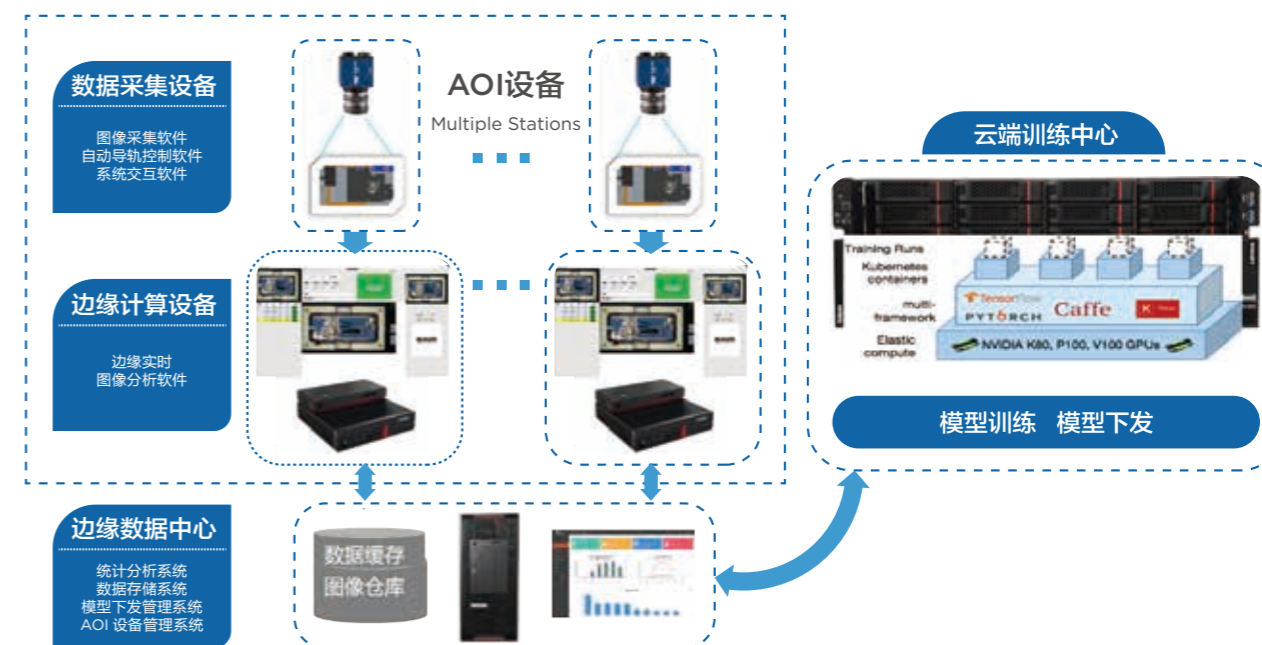
联想视觉技术品质检测方案系统架构图
